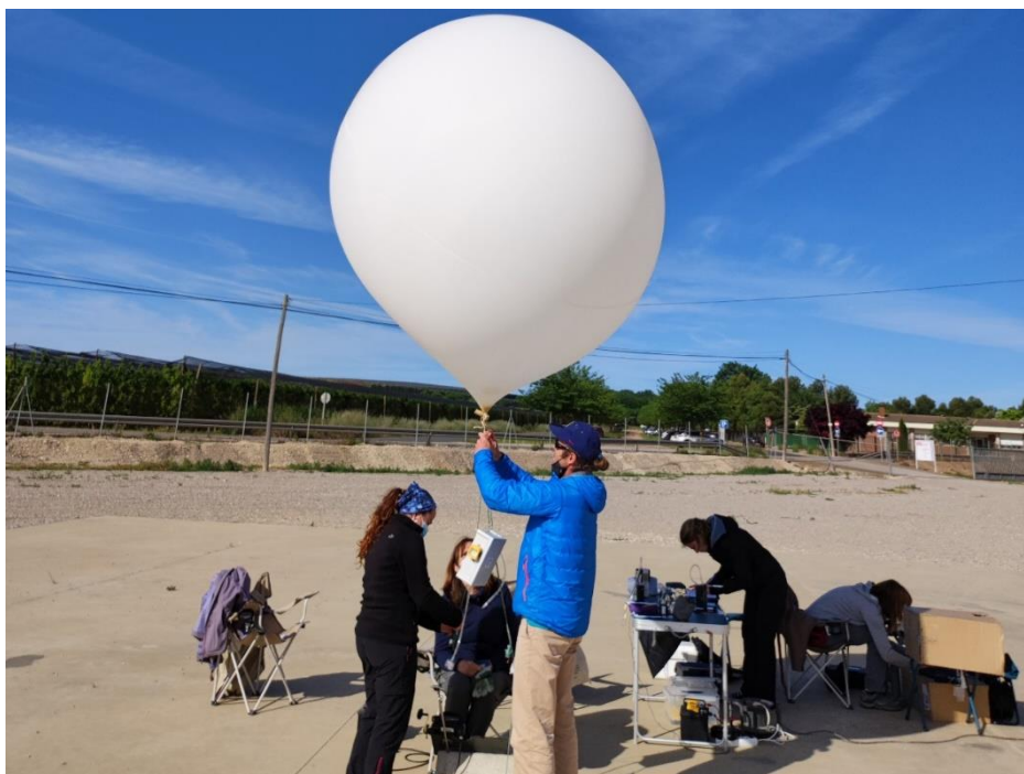
equipo científico del IDAEA-CSIC prepara el globo aerostático para analizar aerosoles orgánicos. Fuente: Joan O. Grimalt
